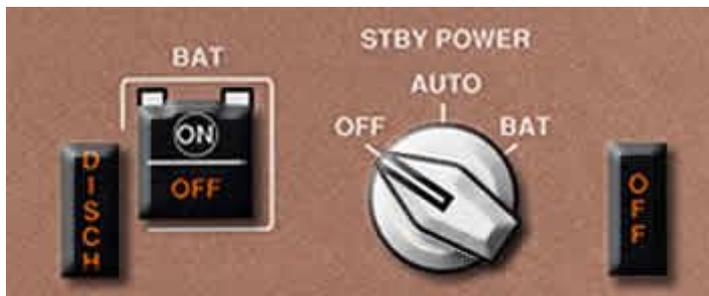
Une fois la batterie la batterie ON, l'APU peut être enclenchée pour fournir de l'électricité à nos chers passagers ainsi qu'au démarrage des réacteurs, l'APU permettra donc d'activer les moteurs par l'intermédiaire de l'APU bleed. Activez-la, en tournant le bouton APU vers start, il se placera automatiquement vers ON, une fois ces deux étapes accomplies nous procéderons à l'allumage des écrans et de la cabine.
